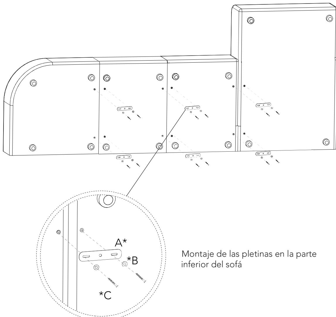
Montaje de las pletinas en la parte inferior del sofá
